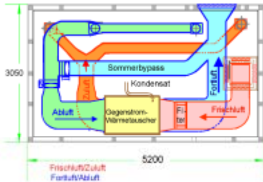
Zentraler Gegenstromwärmeübertrager (Lüftungszentralen auf dem Dach, Entwurf Fa. Innovatec, Projekt HHS/ASP)
