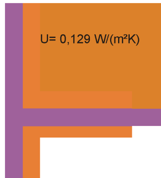
Anschluss Lüftungs- und Entrauchungsschacht Neub.
