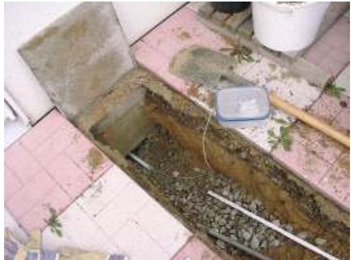
Abbildung 5: Beispiele für die Platzierung von temporären Temperaturfühlern (HOBOS). Links im Badezimmer (Zone 9), rechts unterhalb der Bodenplatte.
